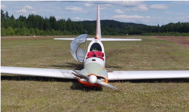
Typisk incident med TMG: skadade propellerspetsar
